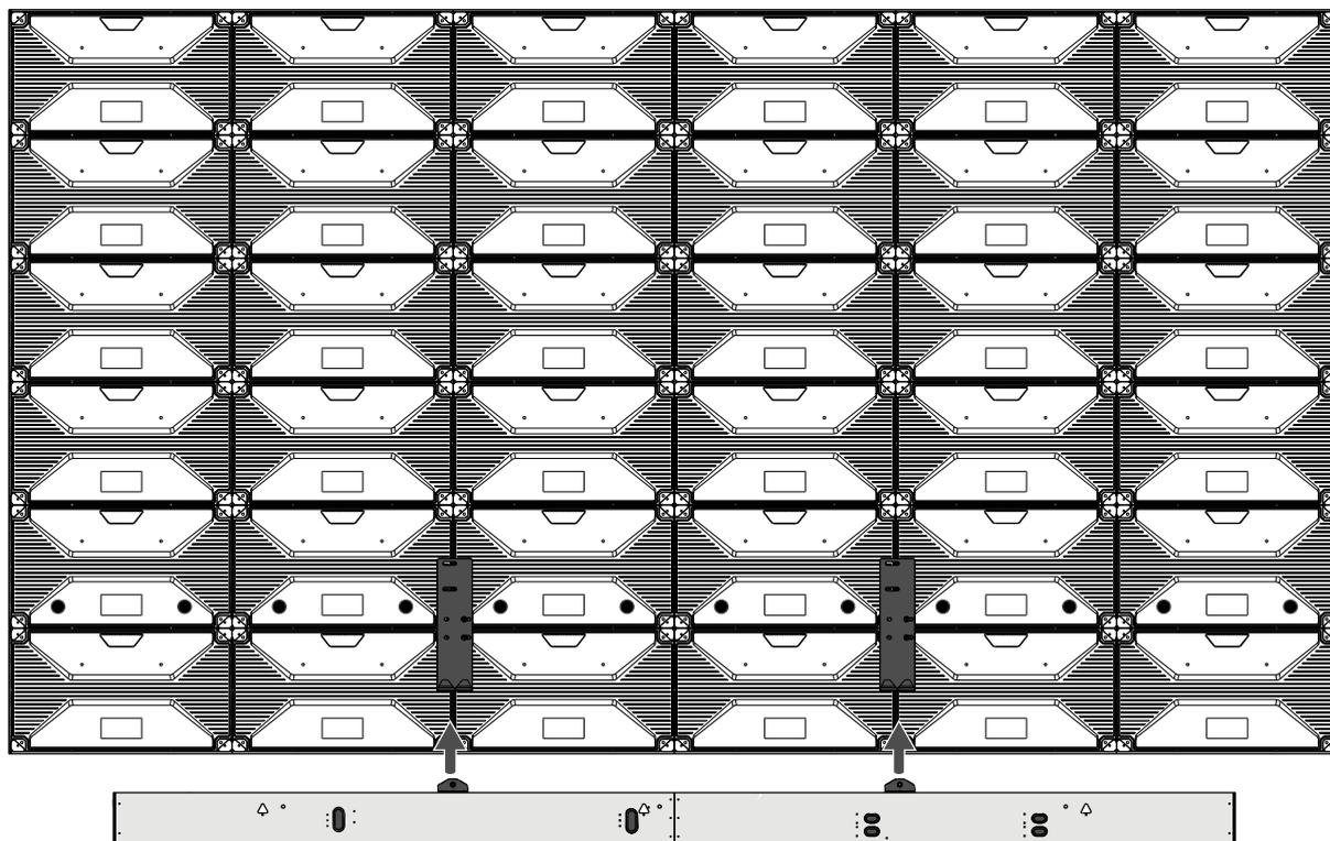
*Untere Systemsteuerbox-Montagehalterung an der Oberseite platzieren
